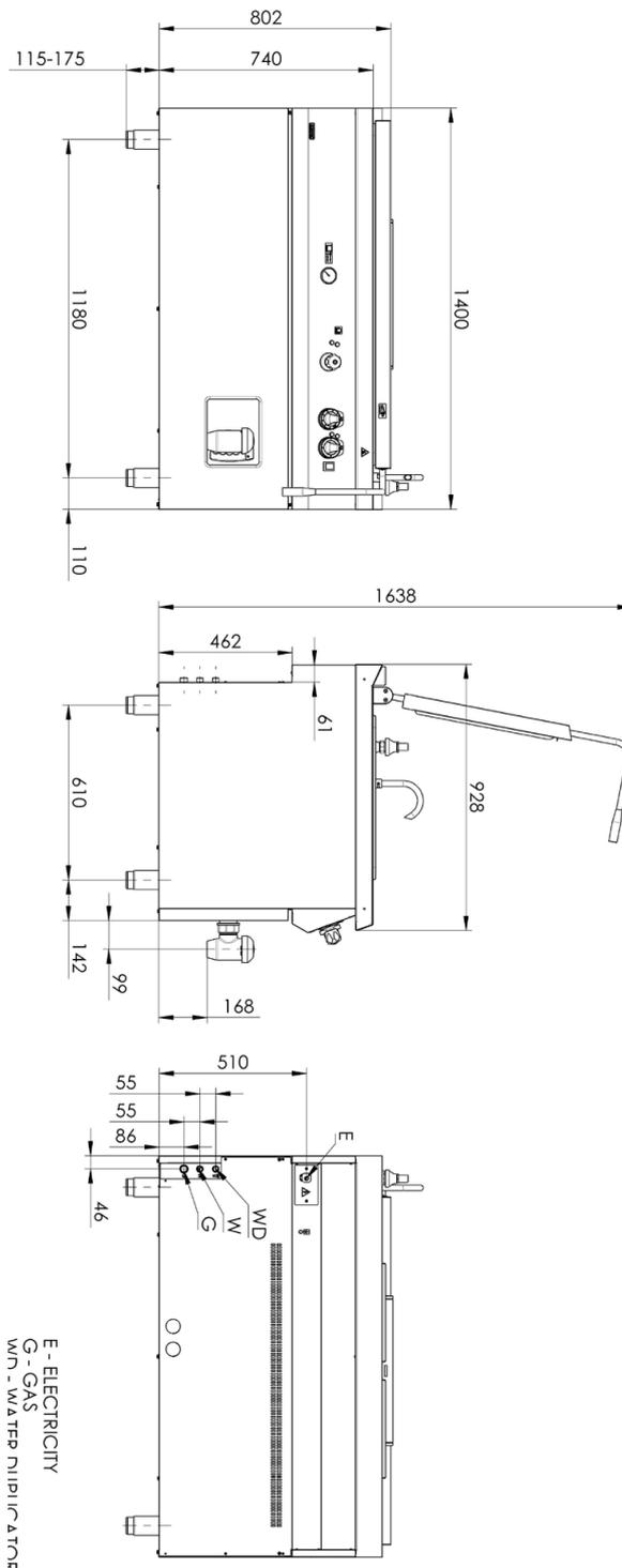
E - přívod napětí 400V
